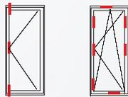
**A- 1** possibilité d'ouverture, et fermée, ma fenêtre est verrouillée sur 3 points, uniquement d'un seul côté.
